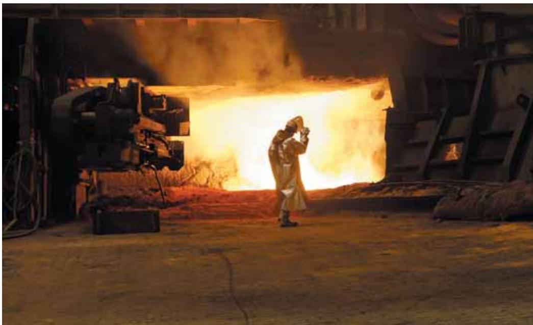
*Im Hochofen wird das Roheisen eingeschmolzen, um zu Stahl weiterverarbeitet zu werden.*
